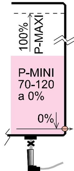
L'alarme F-ALARM pour niveau descendit montre **-TANK-** et l'alarme montante (en ravitaillement) **+TANK+** sur la ligne inférieur de l'afficheur. Les deux s'arrêtent en appuyant brièvement sur St mais recommence si la cause persiste. Cette alarme commande Relais R1 On/Off s'il n'est pas utilisé (programmé à 0) par d'autres fonctions de l'Accucontrol.
